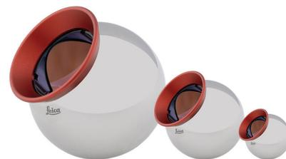
Благодаря автоматическому определению местоположения отражателя, измерениям в реальном времени и способности моментально восстанавливать прерванный луч, измерения лазерными трекерами Hexagon Manufacturing Intelligence по отражателям выполняются быстро, точно и просто. Наш первоклассный выбор отражателей предлагает столь же высокий уровень качества, что и наши измерительные системы, делая оборудование премиум-класса доступным для любой измерительной задачи.
